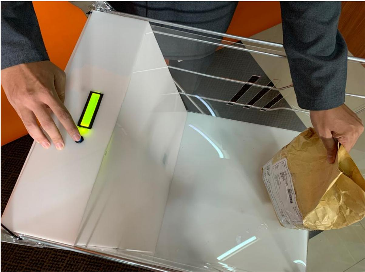
Pembuatan inovasi Trolley dengan sistem RFID ini membutuhkan waktu kurang lebih delapan hari. Dengan rincian delapan hari perakitan sistem RFID, empat hari untuk perancangan kerangka pada trolley, dan satu hari untuk laser *cutting* akrilik.
